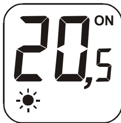
Ejemplo de emisor en modo CONFORT permanente, con consigna de temperatura de 20.5°C y mostrando el estado de salida ON.
